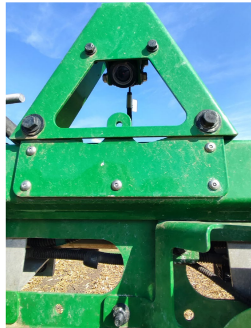
Obr. 8: Online senzor John Deere See&Spray umístěný na aplikačním rámu pro online detekci zaplevelení (vlevo) a mapa aplikace (vpravo) dokládající variabilitu zásahu (foto Brant).
