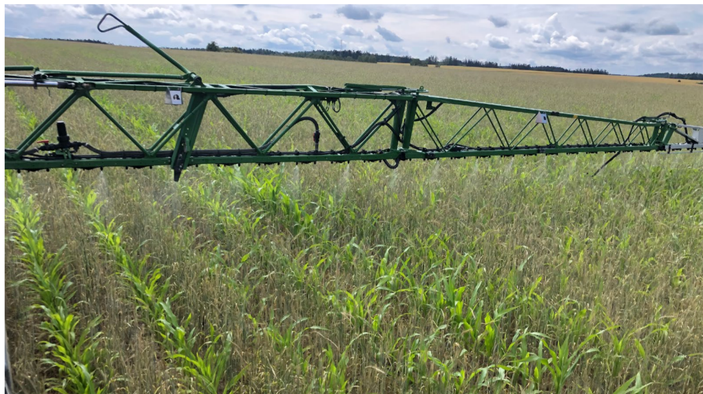
Obr. 3: Pro pásové aplikace lze využít postřikovače s možností individuálního vypínání trysek (foto Cejka).
