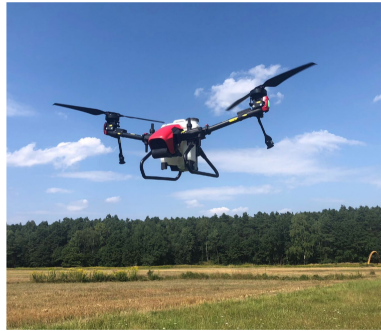
Obr. 7: Aplikační dron XAG V40 vybavený nádrží a tryskami pro aplikaci kapalných látek (foto Chára).
