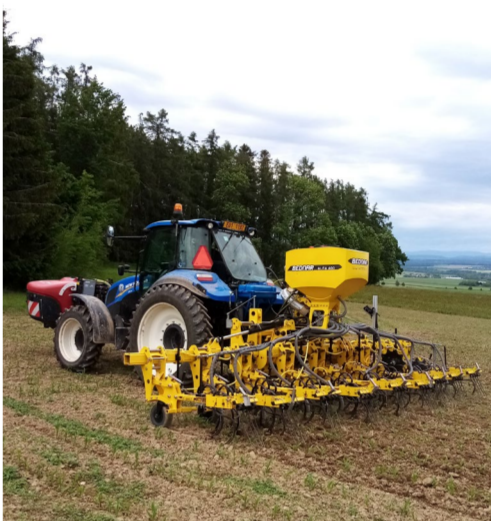
Obr. 4: Aplikace herbicidů na řádek rostliny se souběžnou kultivací mezířadí a s přihnojením rostlin k řádku (foto Brant).
