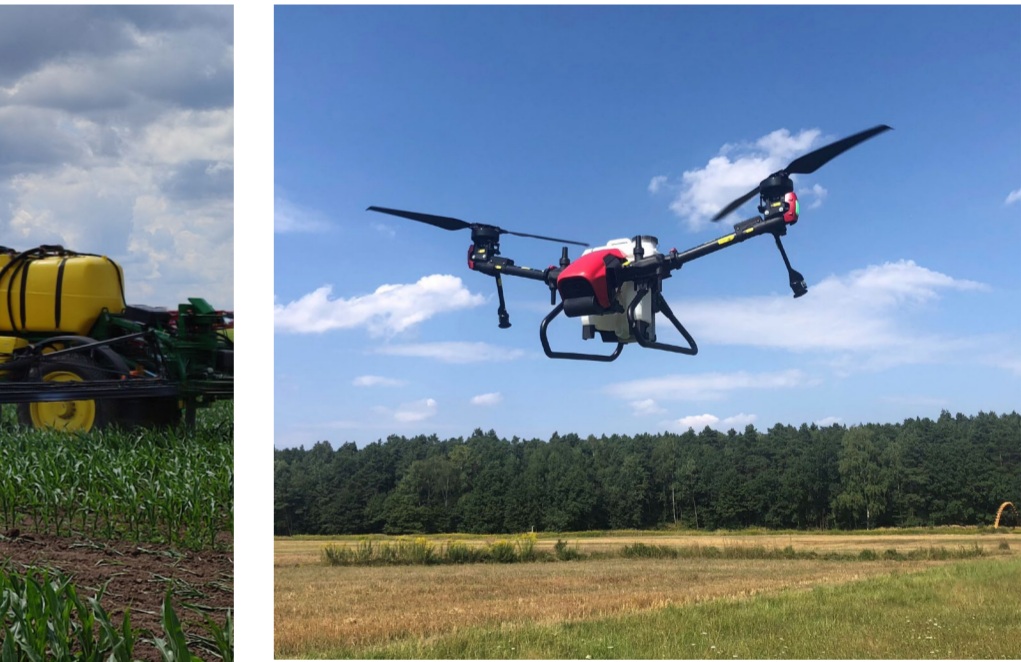
Obr. 7: Aplikační dron XAG V40 vybavený nádrží a tryskami pro aplikaci kapalných látek (foto Chára).
