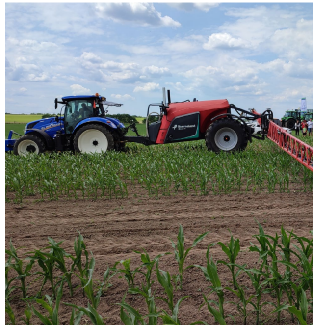
Obr. 6: Postřikovače se sekční kontrolou jednotlivých trysek umožňují provedení zonální aplikace kapalných látek na základě předpisových map (foto Brant).
