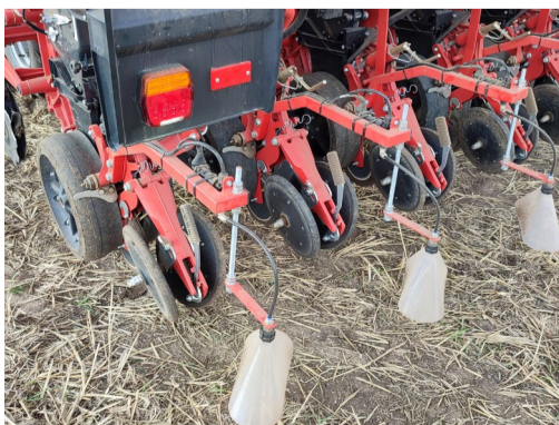
Obr. 1: Pásová aplikace herbicidů při setí plodin do širších řádků (foto Brant).
